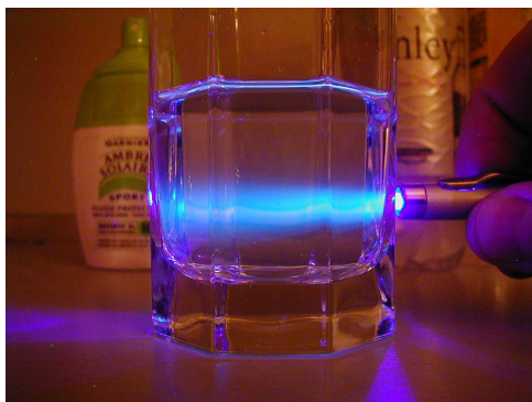
3. ábra. Az UV sugárzás intenzitását a műanyag lemez (CD tok) bevonása fényvédő készítménnyel jelentősen csökkenti.
